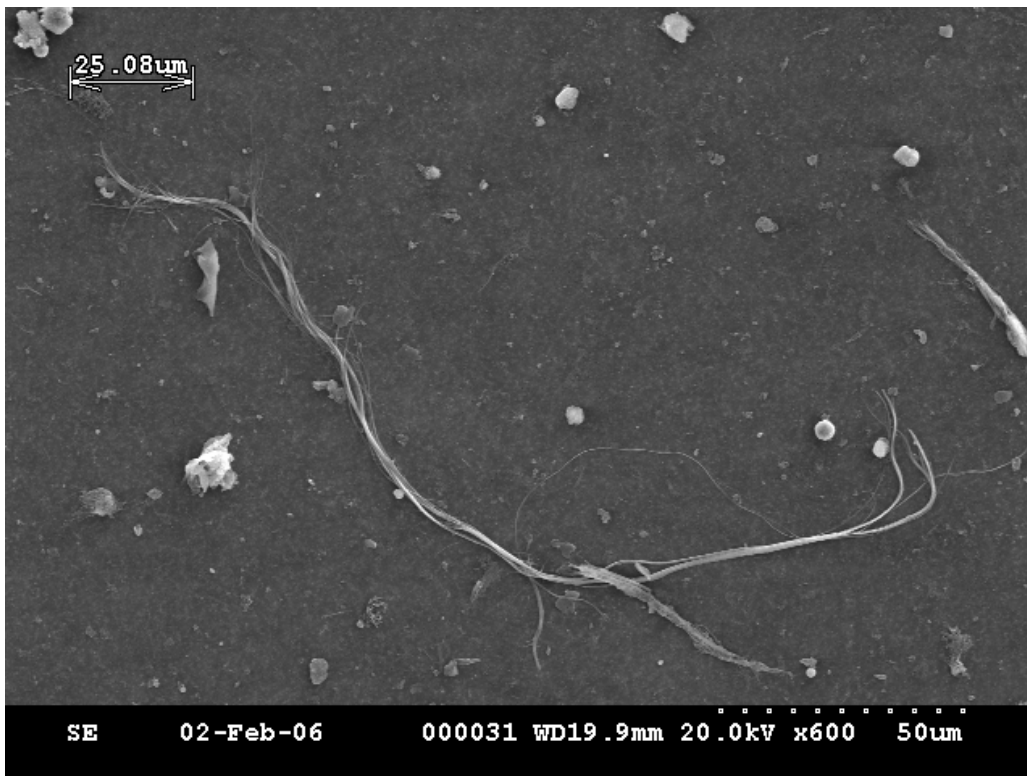
Abb. 2.2 Rasterelektronenmikroskopische Aufnahme zeigt Chrysotilfasern
